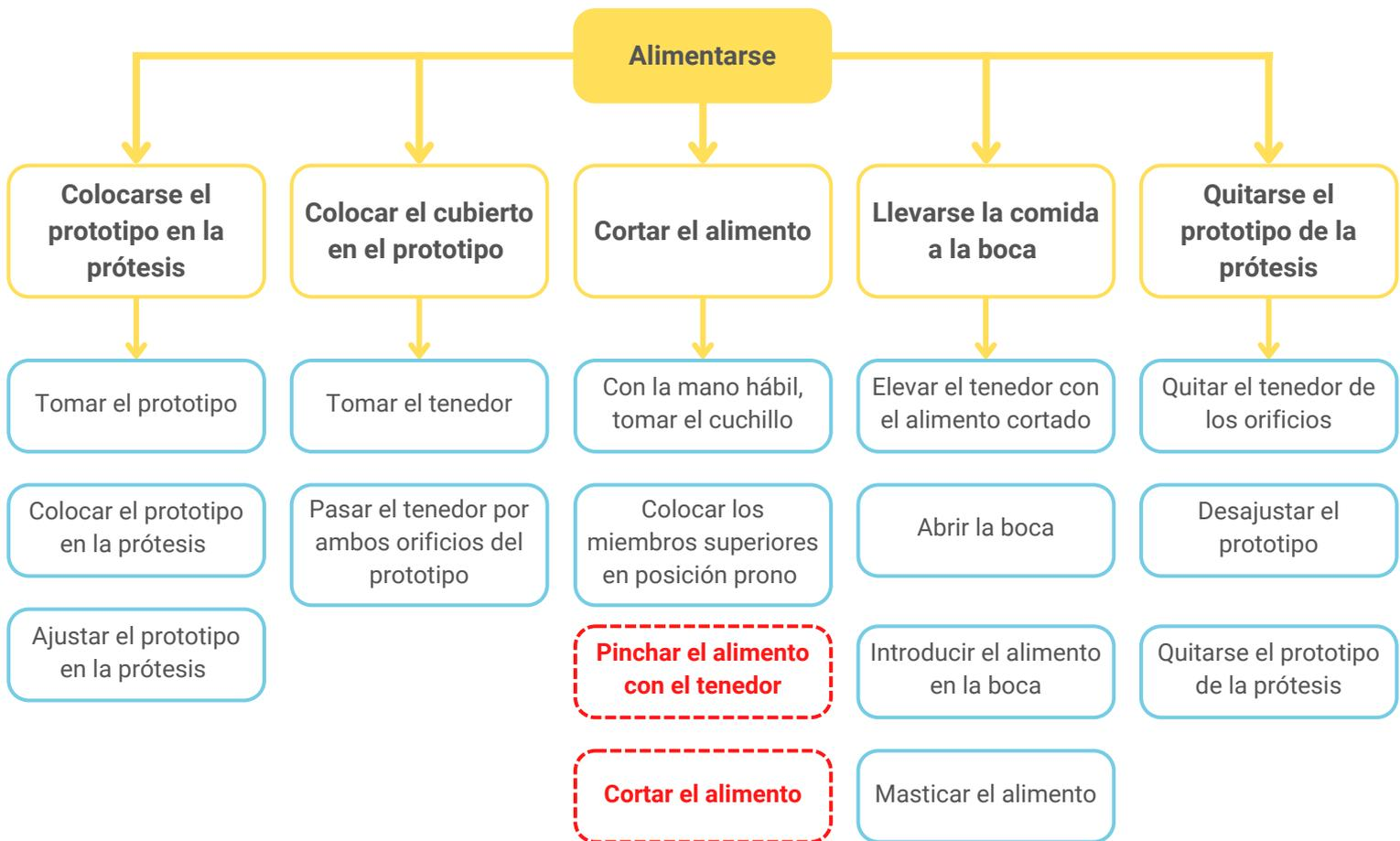
Se detecta un error técnico: cuando el usuario pincha el alimento, la hebilla del prototipo cae sobre el cubierto y el alimento y dificulta la operación. Esto produce que se dificulte cortar el alimento.
