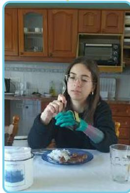
La usuaria no puede pasar el cubierto por el segundo elástico del prototipo
