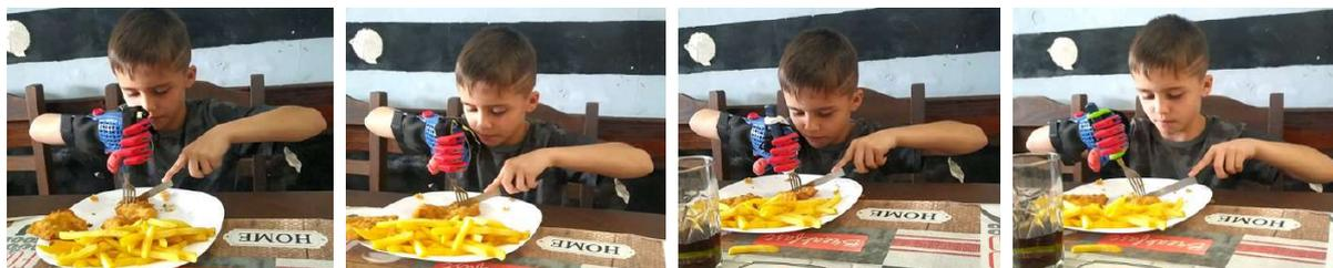
Luego de realizar las secuencias de uso (ver Anexo 31) y los análisis jerárquicos de tareas (ver Anexo 32) podemos identificar que los puntos críticos de los prototipos se presentan al realizar las acciones: colocarse el prototipo en la prótesis, pasar el tenedor por ambos extremos del prototipo, cortar el alimento y quitar el tenedor de ambos extremos.
