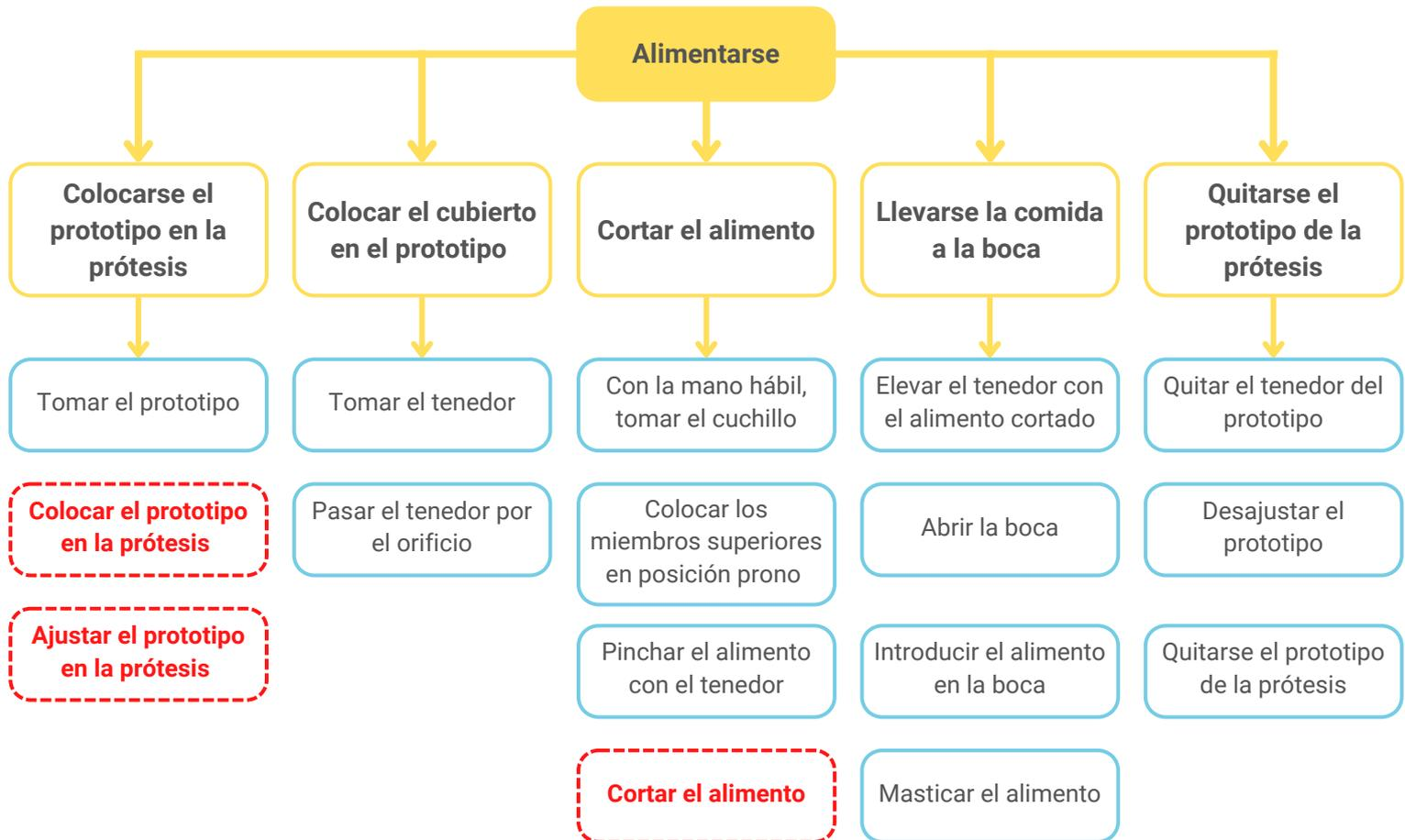
Se encuentran errores de índole técnico y motriz. En las operaciones *colocar el prototipo en la prótesis* y *ajustar el prototipo en la prótesis* visualizamos que el usuario no comprende en primera instancia cómo colocarlo.
